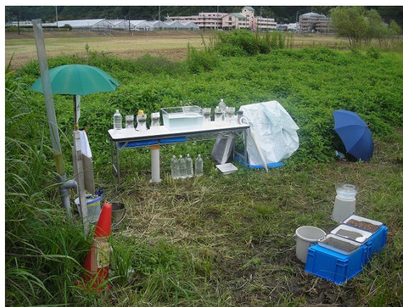
[実験]土のちがいによるしみ込み方
