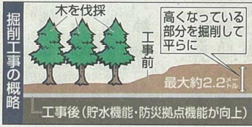
掘削が始まったのは、麻機遊水地第3工区の北側にある「浅畑スポーツ広場」。県静岡土木事務所は広場の高くなっている部分を掘削して平らにすることで、貯水容量を現在より約3万2千立方メートル増やす方針。結果的にヘリポートとしても使
